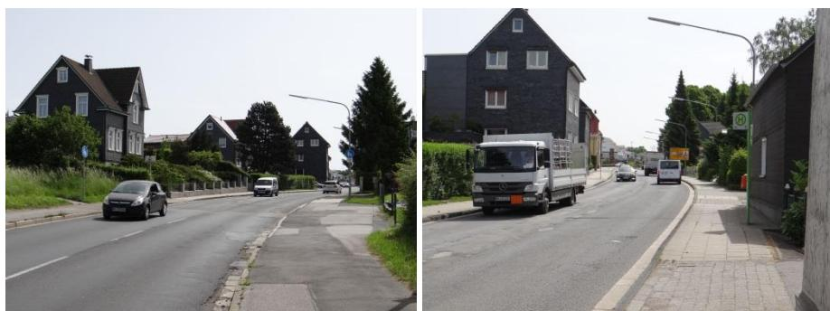
Es wird empfohlen, die Einrichtung eines einseitigen Schutzstreifens stadteinwärts (bergauf) zu prüfen. Bei einer einseitigen Anlage ist die daraus resultierende asymmetrische Anordnung des Straßenraums zu berücksichtigen.
