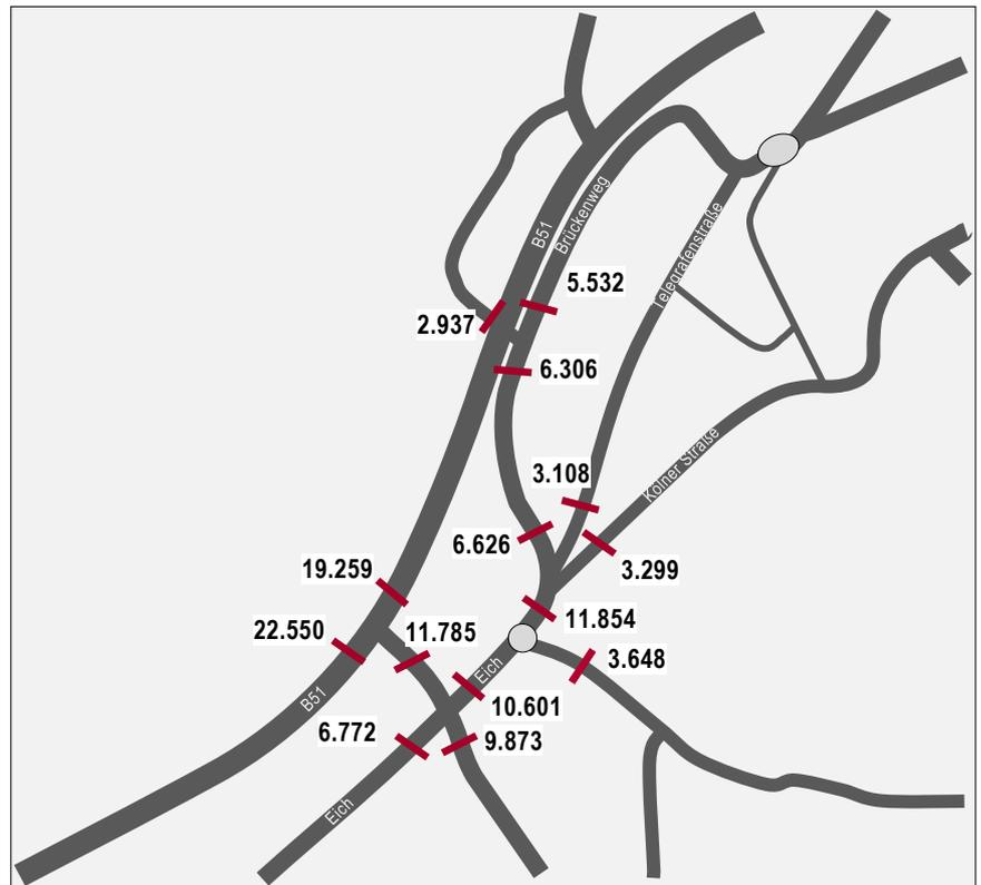
Abbildung 2: Durchschnittlich tägliche Verkehrsstärken – DTV [Kfz/24h] im ANALYSE-Fall
